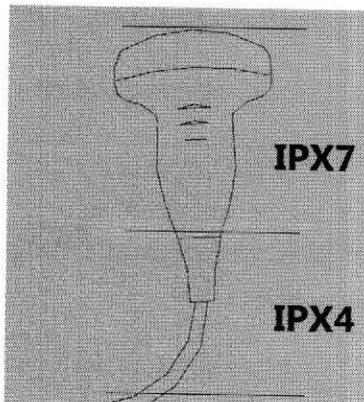
(O nível de prova d'água para todas as sondas convexas, lineares e de phased array podem se referir a esta figura.)
