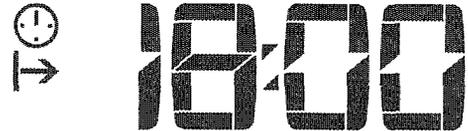
3. Confirme o horário programado apontando o controle remoto em direção à unidade interna e pressionando novamente a Tecla LIGA TIMER no controle remoto. O controle remoto voltará a mostrar o relógio três segundos após a programação.
