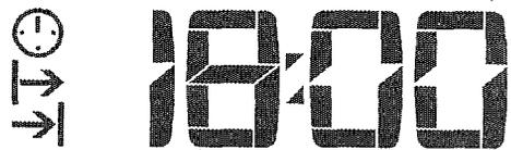
6. Confirme o horário programado apontando o controle remoto em direção à unidade interna e pressionando novamente a Tecla LIGA TIMER no controle remoto. O controle remoto voltará a mostrar o relógio três segundos após a programação.
